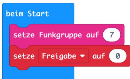
Bei Programmstart wird die Freigabevariable auf 0 gesetzt, sodass ein Drücken auf den Buzzer zwecklos ist.
