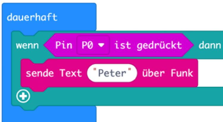
Im Codingteil wird der Zustand des Pins0 abgefragt.
